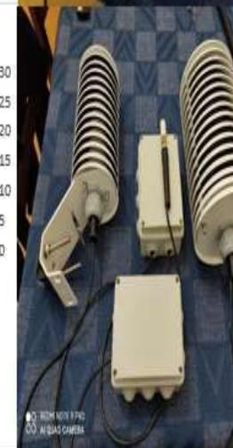
DAVIS 7714(sensore sonda wh31EP ecowitt)-METEOSHIELD PRO (sensore sonda wh32EP ecowitt)
